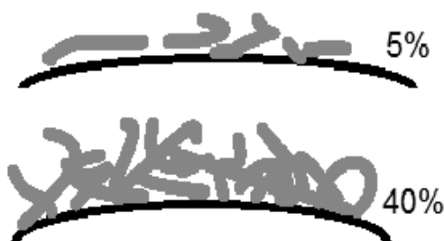
Рис. 5. Схематическое изображение строения адсорбционного слоя полимера на кремнеземе с 5 и 40 % адсорбированного ПФМС
