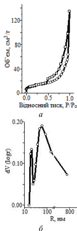
Рис. 4. Адсорбція ( \circ ) та десорбція ( \square ) азоту на зразку літій-залізо фосфату, отриманому цитратним методом, з найбільшим вмістом вуглецю (а) та розподіл пор за радіусами (б)
