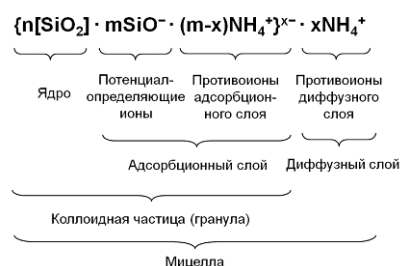
Рис. 2. Схематическое строение мицеллы диоксида кремния в присутствии аммиака в реакционной смеси
