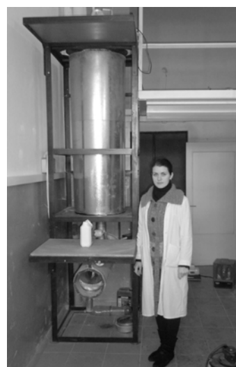
Рис. 2. Установа для аерозольного синтезу каталізатора: схема – а; фотографія – б
